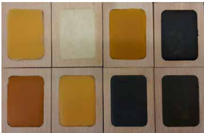
Abbildung: Wachstafeln hergestellt nach verschiedenen Rezepten (von links oben nach rechts unten: 1) 5% Harz 2) Punisches Wachs 3) reines Bienenwachs 4) Rezept 17 Jh. 5) 25% Ocker 6) 10% Kolophonium 7) Holzkohle und 8) 5% Harz, Ocker und Holzkohle)
